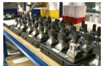
Bild 10 und 11: Neben dem klassischen Formenbau bietet LSM auch Laserschweißen sowie den Handel von Elektrodenrohlingen. Die Elektrodenhalter stammen aus der eigenen Fertigung
