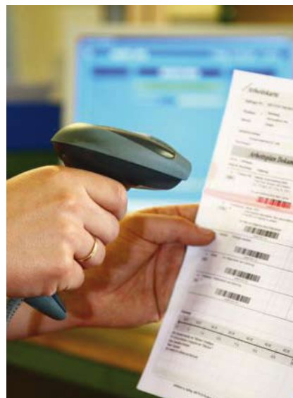
Bild 3 (links): Die Arbeitspläne begleiten das Bauteil als fester Verbund durch die Fertigung. Über den auf dem Arbeitsplan angedruckten Strichcode wird die Zeit per Barcodescanner erfasst
