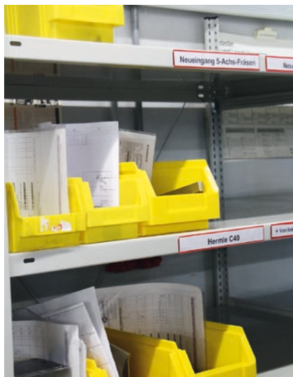
In den Regalen bildet sich der in der Software hinterlegte Workflow ab: Hier warten die Aufträge, sortiert nach Priorität, auf ihre Bearbeitung.
