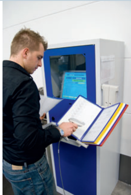
BDE-Terminal: Klar strukturierte Arbeitspläne machen Informationen für alle Einzelteile im Werkzeugbau transparent. Der auf dem Arbeitsplan angedruckte Strichcode dient dabei zur Zeiterfassung.
