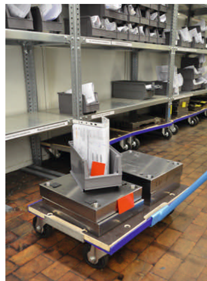
Für große Brocken: Werkstücke, die nicht ins Regal passen, lagern auf Wagen. Auch hier ist die Zuordnung durch die Farben auf einen Blick klar.
