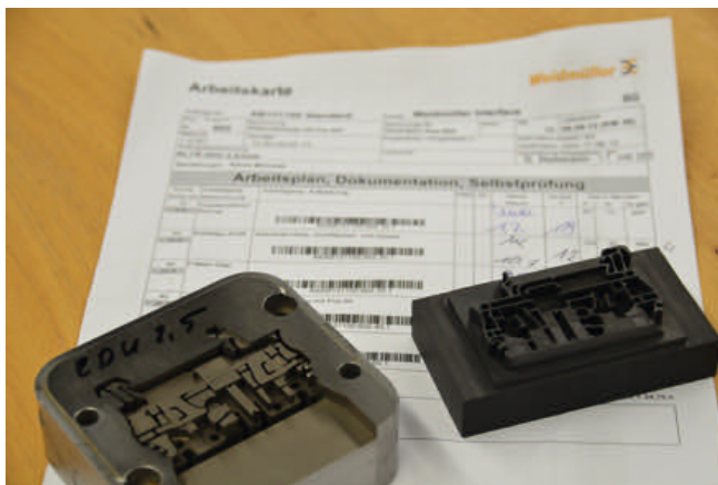
Filigran: Mit diesen Werkzeugeinsätzen werden später Gehäuse für Weidmüller-Produkte produziert. Die Bearbeitung erfolgte in diesem Fall mittels Fräsen, Schleifen, Erodieren mit Grafitelektroden und Polieren auf dem eigenen Maschinenpark.
